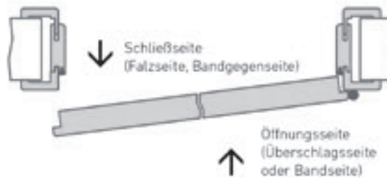
Anschlagrichtung rechts im Querschnitt
