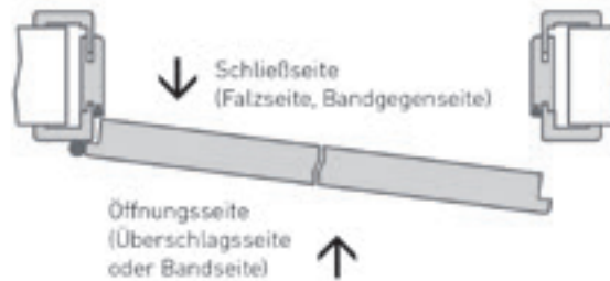
Anschlagrichtung links im Querschnitt
